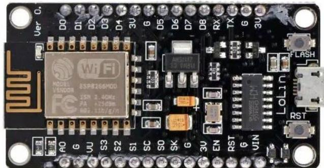
**Gambar 1.**Mikrokontroler NodeMCU
