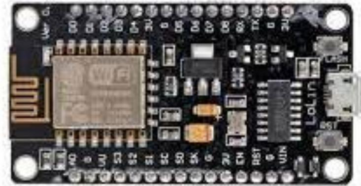
Gambar 1. NodeMCU ESP8266
