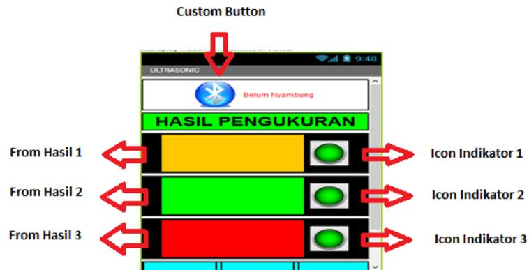
Gambar 25. Desain *Interface* atau Antarmuka
